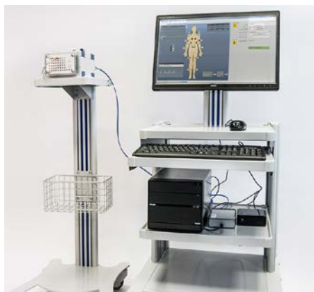
Nový celotělový vícekanálový impedanční monitor MBM konstruovaný v rámci projektu PRECEDENCE
