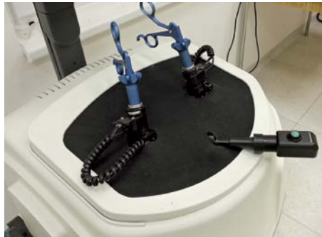
Detail konzole simulátoru, kamera – černá barva, pracovní nástroje – modré barvy
