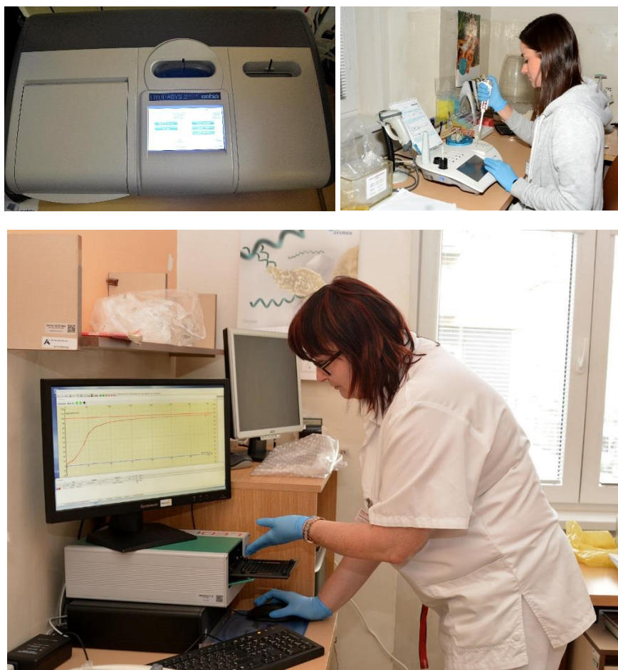
Elektroforetický systém Hydrasys 2 SCAN pro stanovení variančních hemoglobinů a multimerů vWf.
